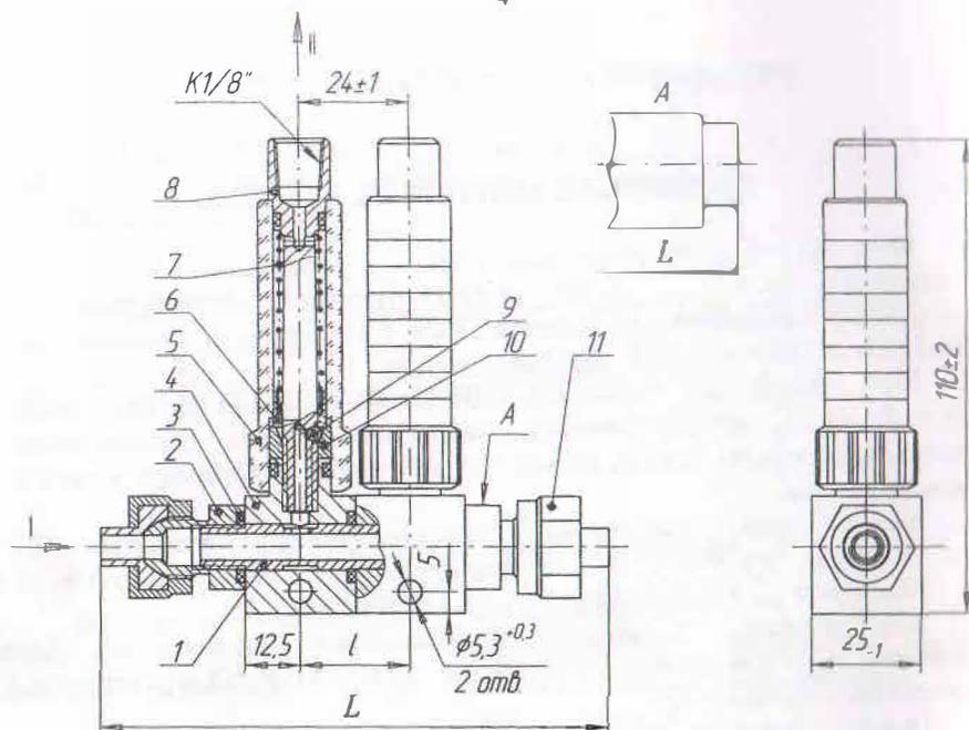
1-шпилька; 2-штуцер; 3-кольцо; 4-корпус; 5-трубка; 6-поплавок; 7-пружина; 8-стержень; 9-шарик; 10-гайка; 11-соединения для сообщения с трубопроводом  $\varnothing 8 \times 1$ ;
