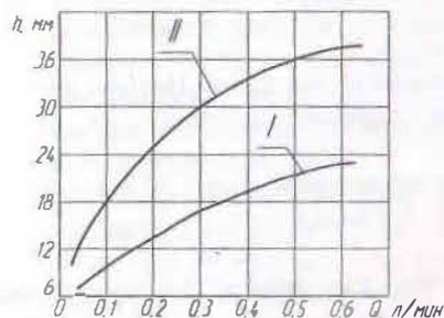
Рисунок 2 – Зависимость перемещения поплавка (от исходного положения) от расхода смазочного материала
