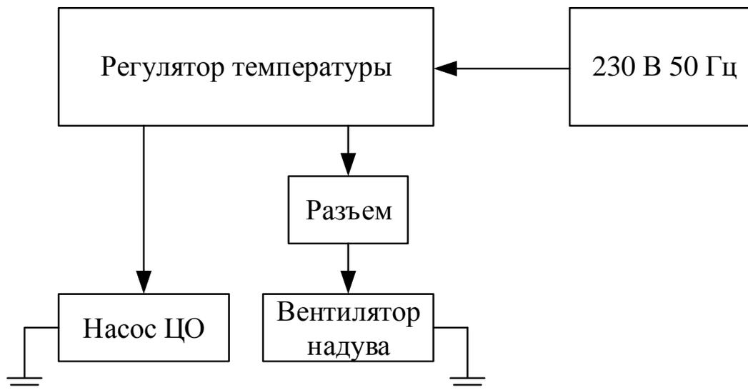
Рисунок 1 – Схема подключения AIR LOGIC +
