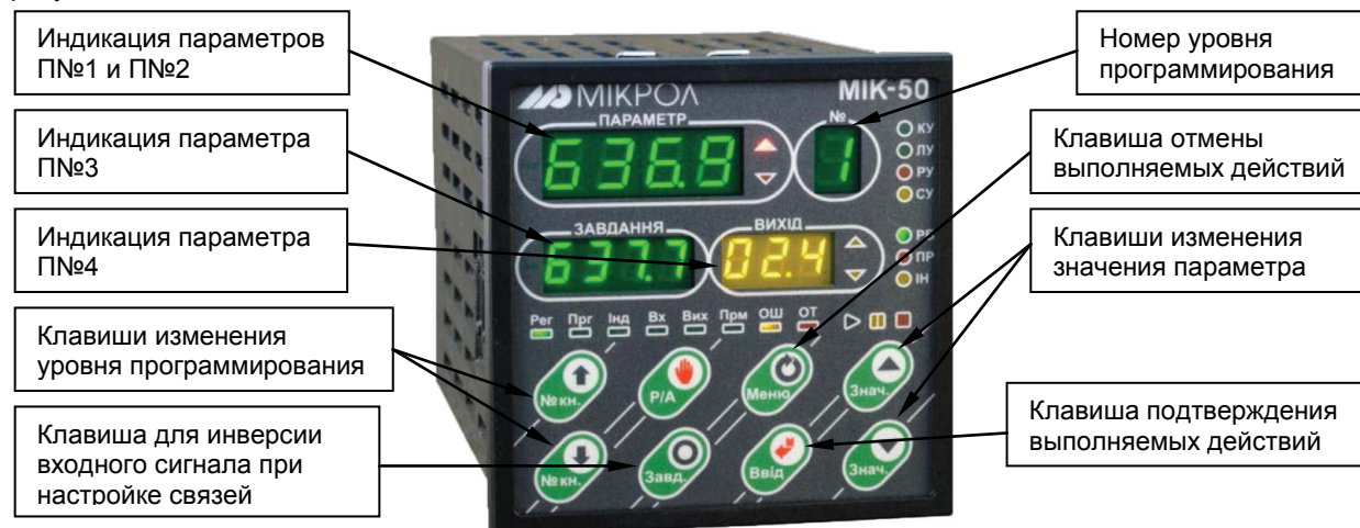
Рисунок 5.1 - Лицевая панель контроллера МИК-50 в режиме программирования
