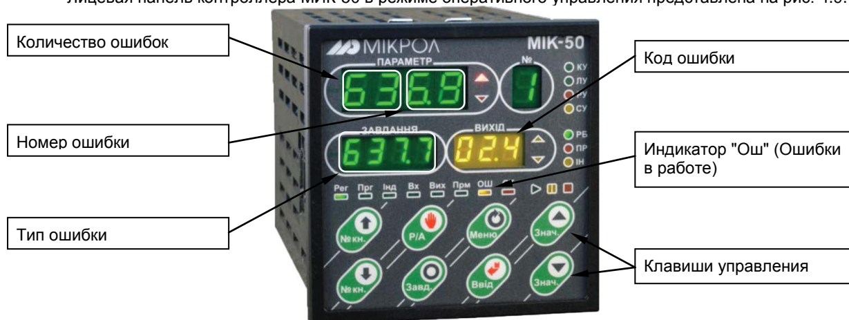
Рисунок 4.9 - Лицевая панель в режиме индикации ошибок
