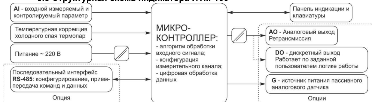
Рисунок 3.2 - Структурная схема индикатора ИТМ-100
