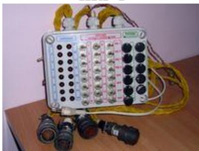
Настоящая инструкция служит для ознакомления работников (наладчиков) пусконаладочных и обслуживающих организаций с работой пульта контроля работоспособности ПКР-1.
