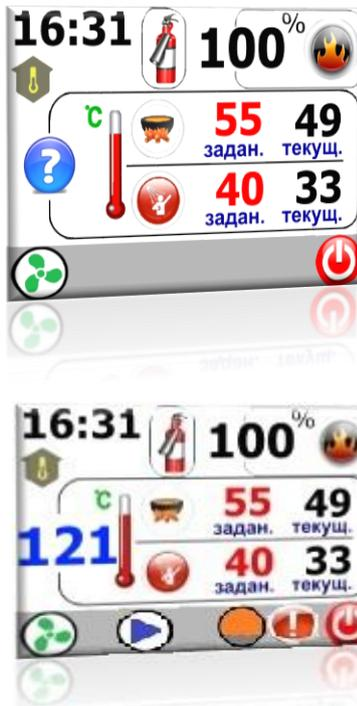
**Авария датчика темп. дымовых газов** – заменить датчик температуры дымовых газов. Контроллер переходит в аварийный режим, включает насосы ЦО и ГВС.
