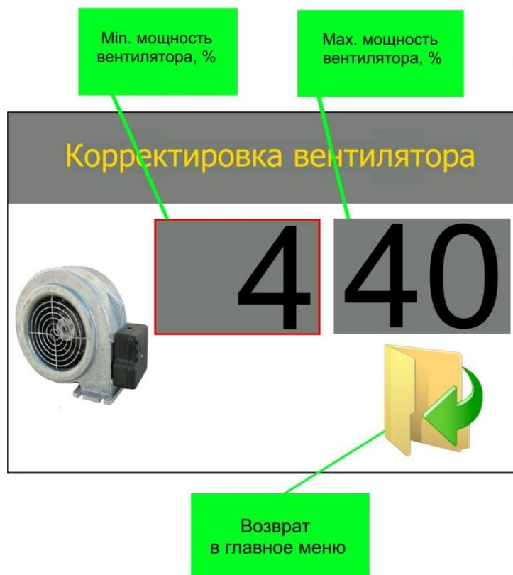
Рисунок 17 – Окно изменения мощности вентилятора (розжиг)
