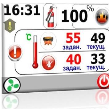
**Перегрев датчика темп. дымовых газов** – температура дымовых газов достигла значение установленного в пункте 4.1 «Безопасность». Контроллер переходит в режим аварийного гашения.
