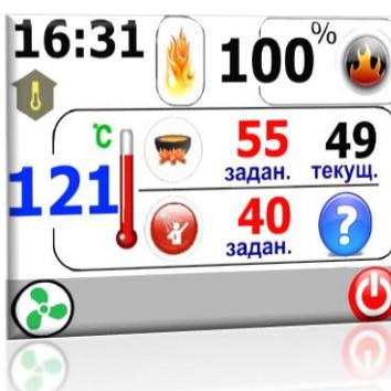
**Авария датчика темп. ГВС** – замените датчик темп. ГВС. Котел по-прежнему работает, переключается на приоритет отопления домом. Не запускается насос ГВС.
