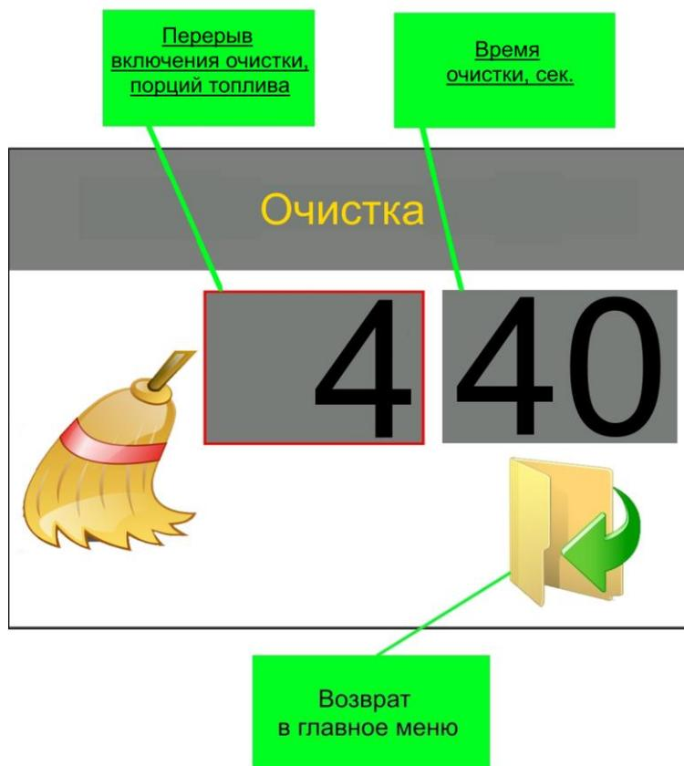
Рисунок 13 – Окно настройки параметров очистки горелки
