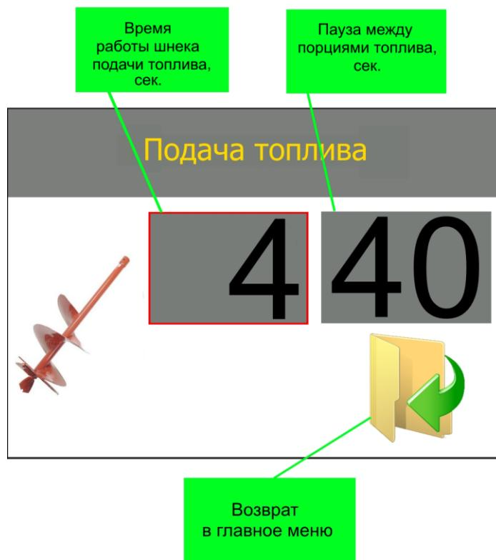
Рисунок 11 – Окно настройки параметров подачи топлива
