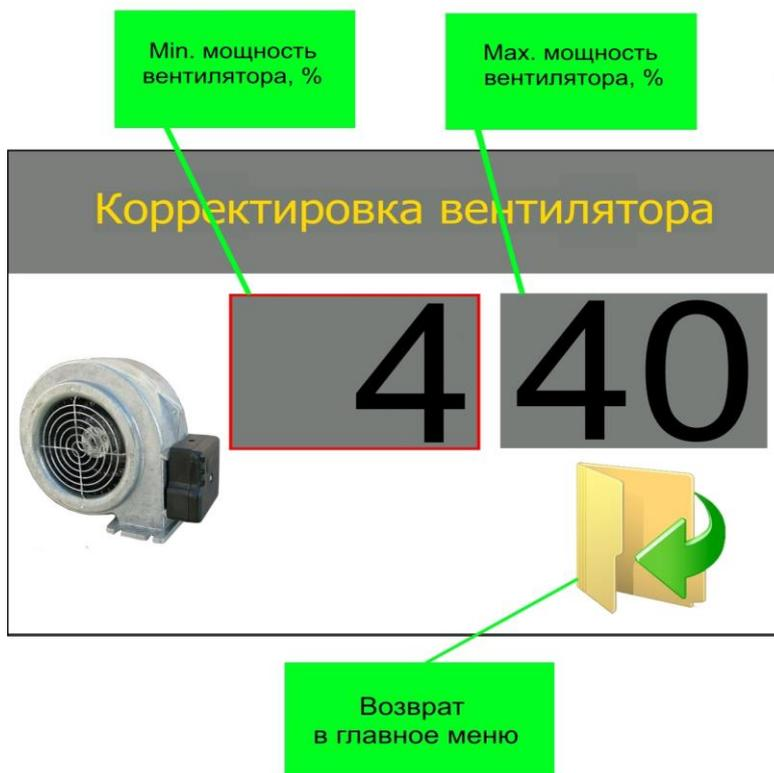
Рисунок 12 – Окно корректировки вентилятора
