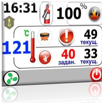
**Перегрев котла** – температура теплоносителя достигла значения установленного в пункте 4.1 «Безопасность». Контроллер переходит в режим аварийного гашения. Автоматически включаются насосы ЦО и ГВС.
