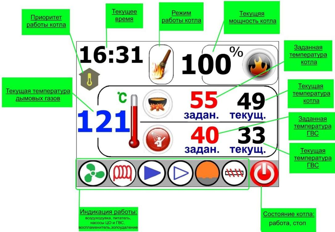
Рисунок 4 – Главный экран AIR BIO PID
