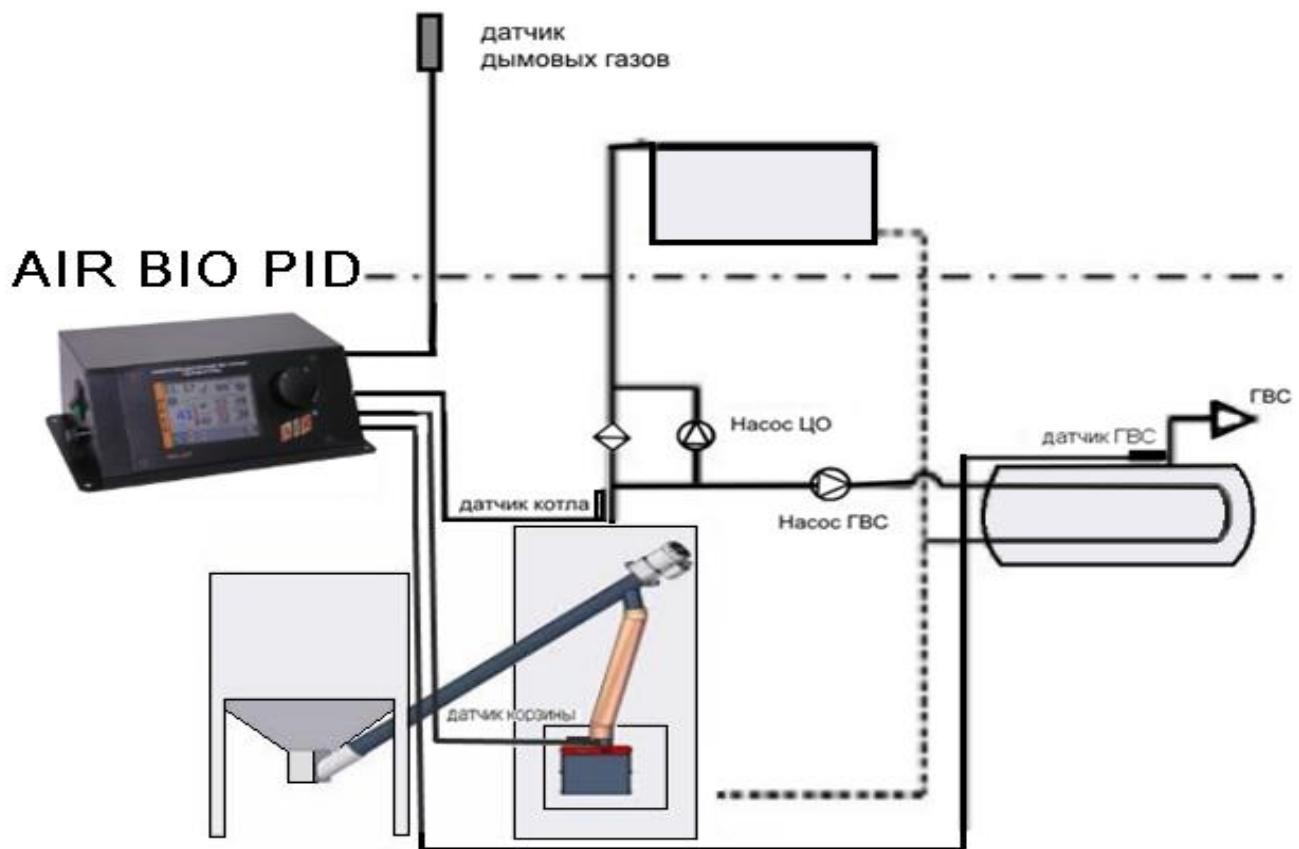
Рис.1 - Схема подключения AIR BIO.
