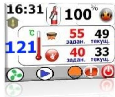
**Авария датчика темп. корзины** – температура пеллетоприемника достигла значения установленного в пункте 5.1 «Безопасность». Котел переходит в режим СТОП, автоматически включаются насосы ЦО и ГВС.
