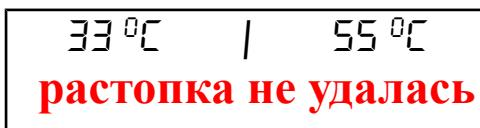
В этом случае следует заново запустить функцию *растопки*, регулятор повторно начнет процесс расплавления.
