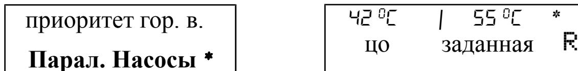
В этом режиме работа насосов начинается одновременно при превышении температуры включения насосов (фабрично установленные на 35°C). Насос Ц.О. работает все время, а насос гор. воды выключается после достижения заданной температуры на бойлере; его повторное включение наступает после понижения температуры на 2°C.
