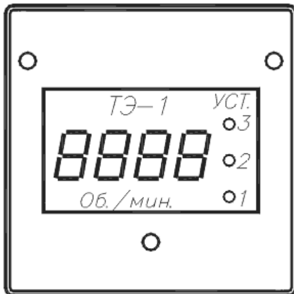
Рисунок 1 - Эскиз передней панели устройства индикации ТЭ-1
