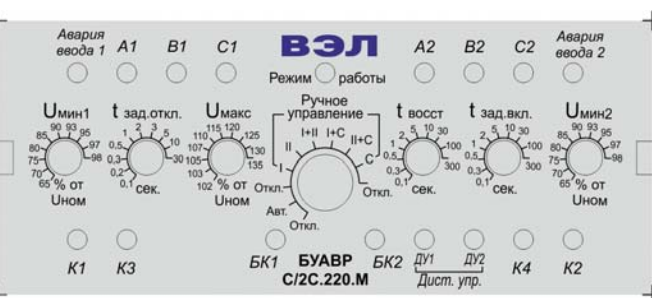
Рис. 4 Расположение органов управления и индикации БУАВР.С и БУАВР.2С
