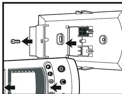
**4.** В выбранном месте прикрепить к стене основание терmostата, обращая внимание, чтобы основание полностью закрывало отверстие в стене. Провода следует просунуть через отверстие в предохранительной крышке (Рис. 2.3).
