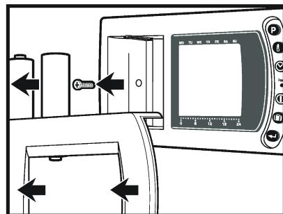
**3.** Вывернуть нажимной винт и снять предохранительную крышку .
