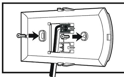
**5.** Два провода подключить соответственно к зажимам 1 и 2. Стандартные варианты соединения представлены на рисунках 3.1, 3.2 і 3.3 (без нулевого или заземляющего провода).
